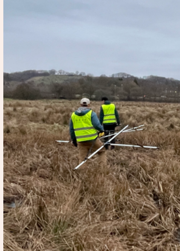
Den del af sTEM-udstyret, som udgør senderen, placeres i landskabet. Læs mere om sTEM i boksen på s. 21.
