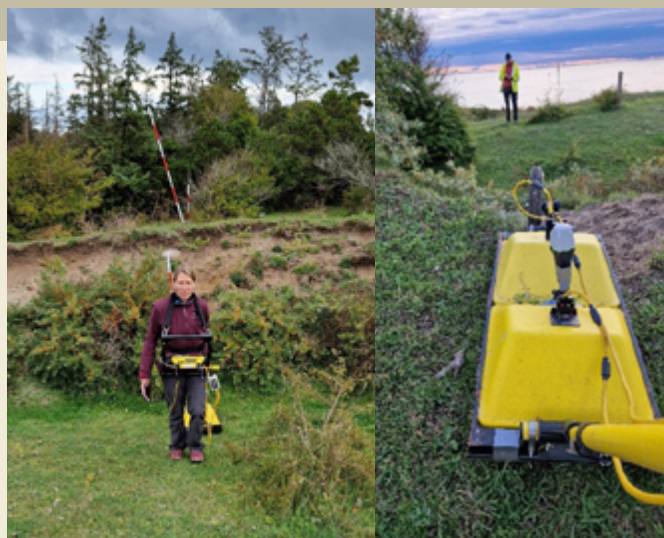
Tv. er der georadar-dataindsamling ved bagvæggen af et aktivt landskred på Røsnæs, og th. ses et nærbillede af sender og modtager.
